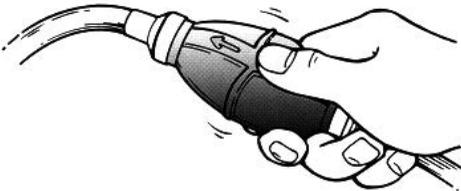
3) Жмите на заливочную грушу дотех пор, пока не почувствуете, что она стала твёрдой на ощупь.
