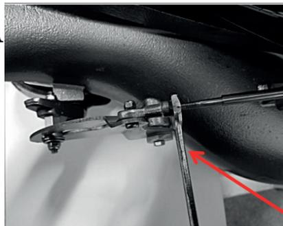
**С - ИСПОЛЬЗУЙТЕ ГАЕЧНЫЙ КЛЮЧ, ЧТОБЫ ЗАТЯНУТЬ ГАЙКУ**
