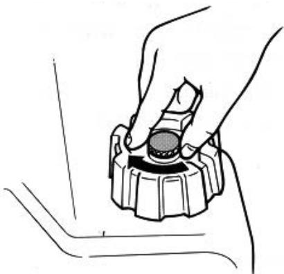
3) После того как двигатель остановился, заверните болт вентиляционного отверстия на крышке топливного бака, (если он имеется).
