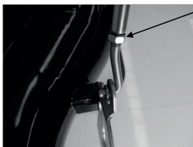
**А - РЕГУЛИРОВОЧНАЯ ГАЙКА**
